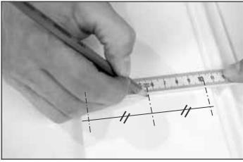
**1** Сделайте разметку на изделии для последующего высверливания места под светодиодный вкладыш.
