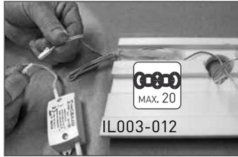
**6** Соедините светодиоды между собой с помощью кабеля. На один преобразователь напряжения максимально — 5 светодиодов.
