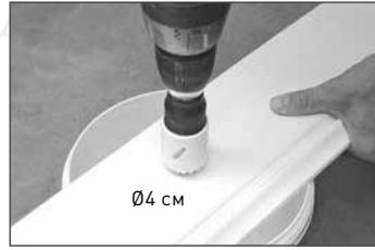
**3** Высверлите отверстия под светодиоды диаметром 4 см.
